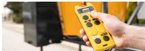
Otevírání výsypu a rychlost šneku mohou být ovládány dálkovým ovladačem.
