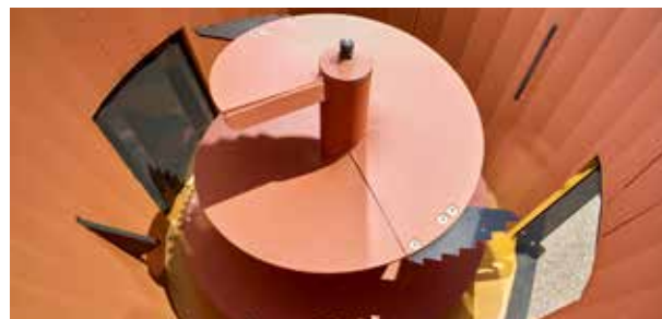
Vertikální šnek a kónusový tvar zásobníku zaručují perfektní nařezání a promíchání krmiva.
