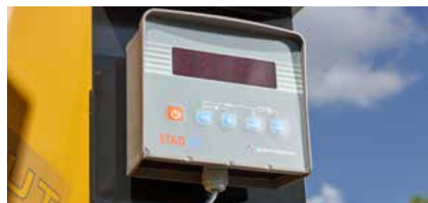
Elektronická váha zaručuje přesné dávkování komponent.
